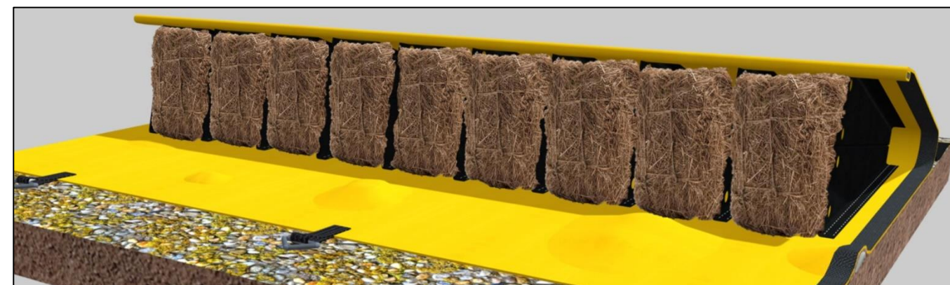
Figure 62 : Exemple de système type « barrage filtrants » (source : WaterGate)
